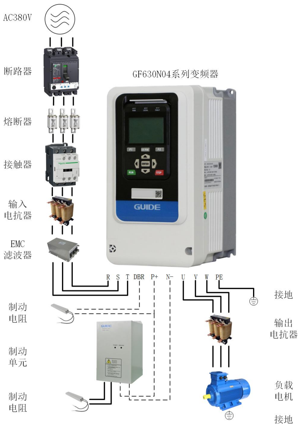
GF630N04 变频系统外围电气元件的使用说明
